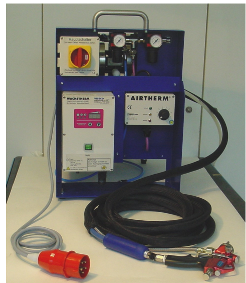
Das Heißspritzsystem: Der Airtherm zusammen mit beheiztem Materialschlauch und Doppelmembranpumpe.
